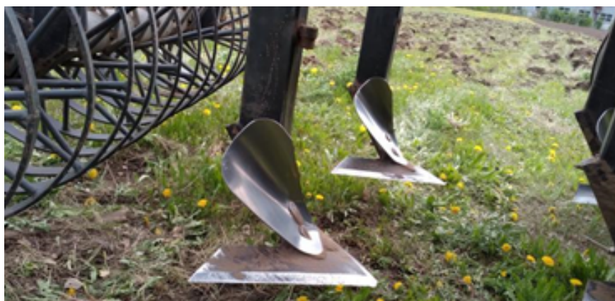
Рис. 3. Культиваторная лапа, оснащенная специальным отвалом
