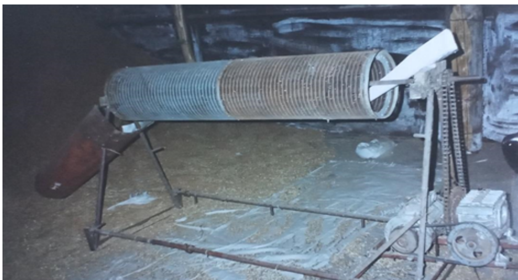
Рисунок 1 Самодельное (изготовленное фермером Кузекеевым В.Н.) зерноочистительное устройство для очистки зерна пшеницы от семян сорняков в виде цилиндрического решета (с продолговатыми отверстиями 2,2 x 16 мм, внутренним диаметром 315 мм, длиной 1580 мм, частотой вращения 50 мин -1 и производительностью 0,9 т/ч).
