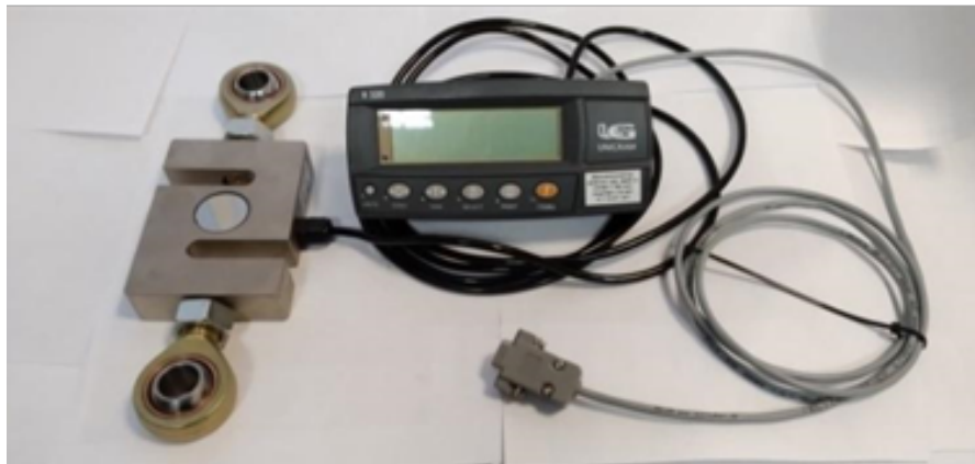
Рис. 2. Динамометр ДЭП/3-1Д-50Р-2 для определения тягового сопротивления
