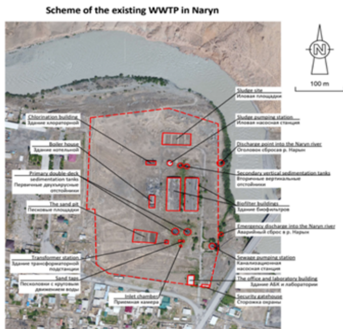
Рис.1. Существующие канализационно-очистные станции (КОС).
