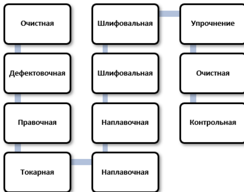
Рис. 1. Схема ремонта коленчатого вала
