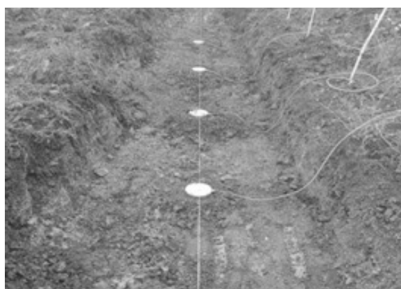
Рис. 1. Установка датчиков давления в почве на глубину 20 см. Источник: «Составлено авторами»
