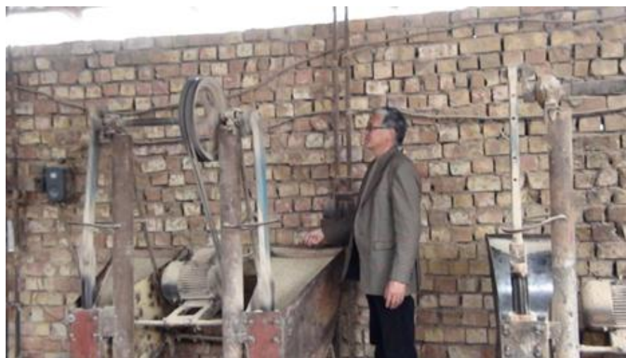
Рис. 4. Очистка риса в электрической мельнице – акжузе.
