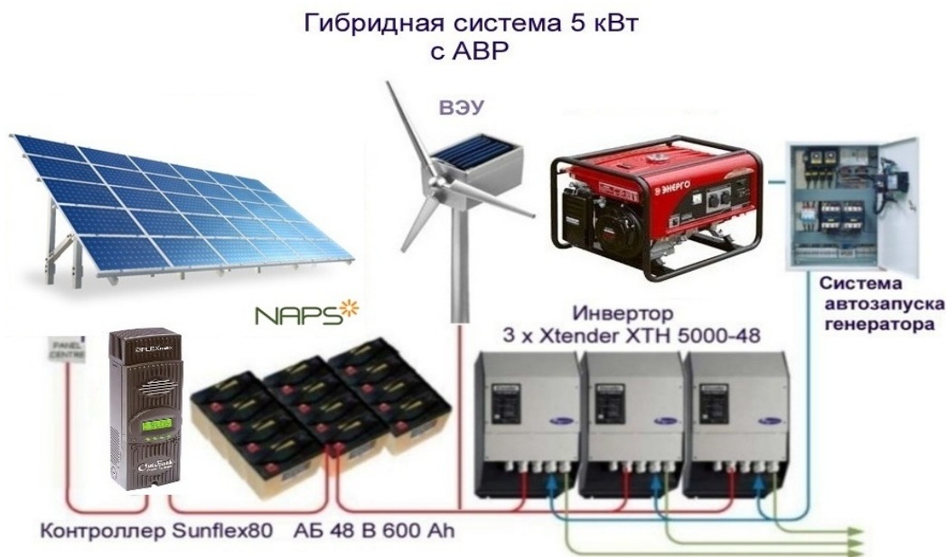
Рис. 3. Автономная гибридная система электроснабжения.
