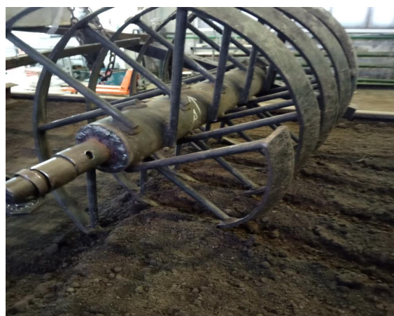
Рис. 2. Экспериментальный образец винтового катка, изготовленный для лабораторных исследований в почвенном канале
