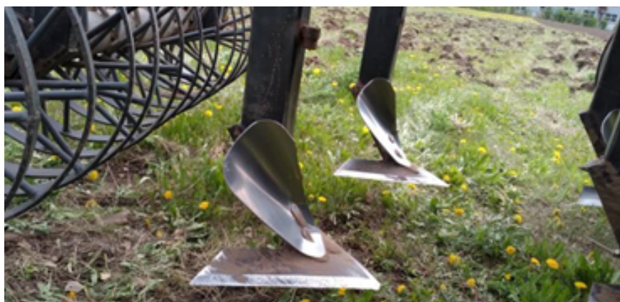
Рис. 3. Культиваторная лапа, оснащенная специальным отвалом
