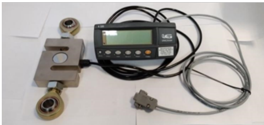
Рис. 2. Динамометр ДЭП/3-1Д-50Р-2 для определения тягового сопротивления
