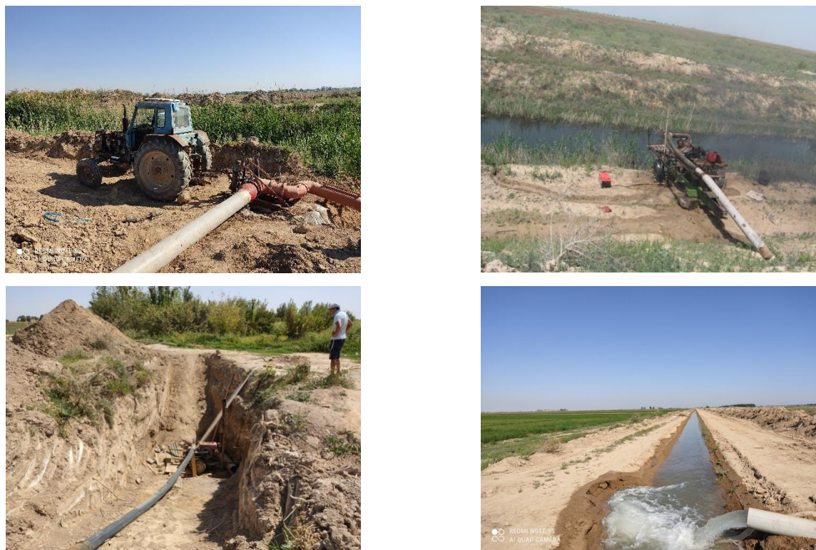
Рис. 3. Забор коллекторно-дренажных вод передвижными насосными установками с коллекторов и расстепление законсервированных СВД для орошения в вегетационный период в Голодностепском массиве бассейна р. Сырдарья
