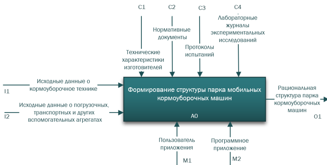
Рис. 1. Диаграмма на основе методологии IDEF0, представляющая функциональную модель приложения для автоматизированного формирования структуры парка мобильных кормоуборочных машин на уровне А0
