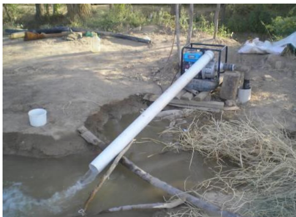
Рис. 2. Использование грунтовых воды для полива с помощью простой насосной установки и процесс смешивания грунтовой воды из скважины вертикального дренажа непосредственно с водой канала
