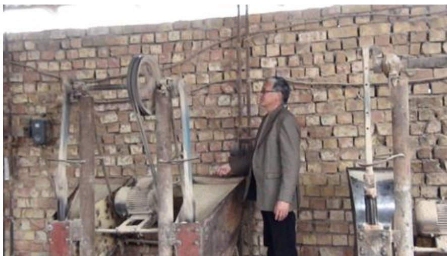
Рис. 4. Очистка риса в электрической мельнице – акжузе.
