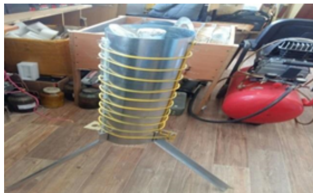
Рисунок 2- а) технологическая схема зерносушилки, б) макет лабораторной установки 1-цилиндрический кожух, 2- электрическая обмотка, 3-транспортирующий шнек, 4- загрузочной лоток, 5 – выгрузочной лоток, 6- воздухоотвод
