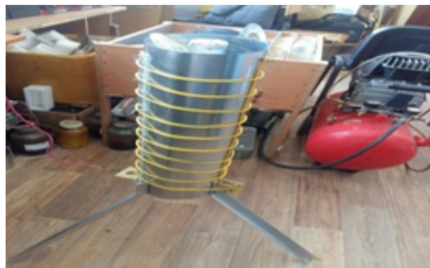
Рисунок 2- а) технологическая схема зерносушилки, б) макет лабораторной установки 1-цилиндрический кожух, 2- электрическая обмотка, 3-транспортирующий шнек, 4- загрузочной лоток, 5 – выгрузной лоток, 6- воздухоотвод
