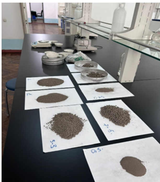
Сүрөт 4-5. Топурактын структуралык анализин аныктоо
