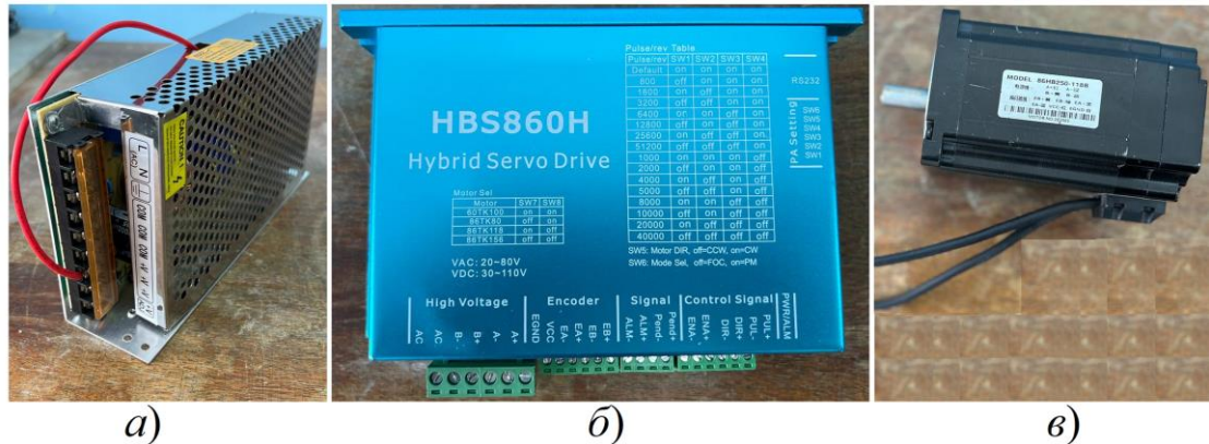
Рис. 5. Элементы шагового электропривода 3 – D фрезерного станка «Составлено по [4]».
