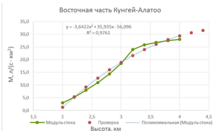
Рис. 4. График зависимости модуля стока восточной части Кунгей Ала-Тоо
