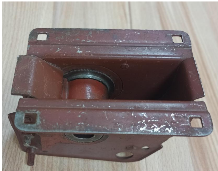
Рис. 1. Высевающий аппарат с ободом-приспособлением.
