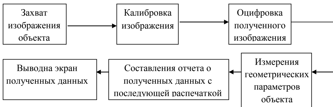
Рисунок 1- Структурная схема алгоритма обработки изображения
